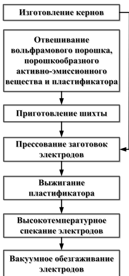
Рис. 4. Схема изготовления экспериментальных образцов спеченных электродов
