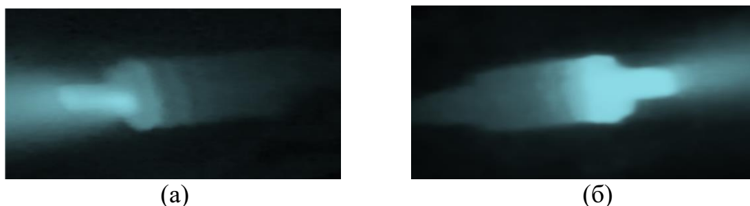
Рис. 9. Фотография термоэлектрода в катодном режиме (а) и в анодном режиме (б)
