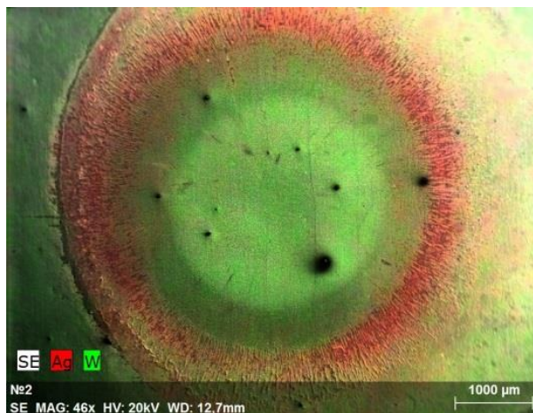
Рис. 9. Изображение образца W-Ag, облученного 20-ю импульсами азотной плазмы на расстоянии 30 мм от анода, полученное на растровом электронном микроскопе, снабженном приставкой для рентгеновского микроанализа. Светлые участки соответствуют вольфраму, темные – серебру
